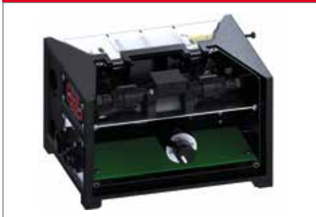
PF5 mit integriertem Gas-Flow-Sensor
