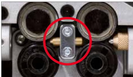
Frontpull 8 Modul mit integriertem Gas-Flow-Sensor
